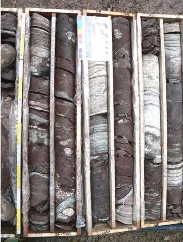
**Abb. 1:** Bohrkernfotos einer Bohrung aus dem Unteren Gipskeuper in Württemberg. Weiße, massige bis dünnbankige, sulfatische Lagen in grauem bis rotbraunem Tonstein
