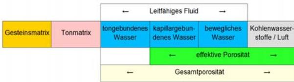
Abb. 3: Standard-Porositätsmodell, nach Prammer et al., 1996
